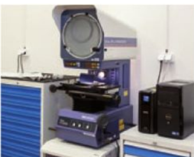
Profilový projektor. Laboratórium kvality managementu.
