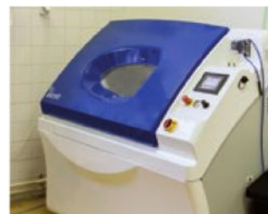
Koróznna komora pre simuláciu extrémnych podmienok a testovanie materiálov.
