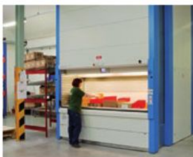
KARDEX. Veľkokapacitný automatizovaný skladovací systém.
